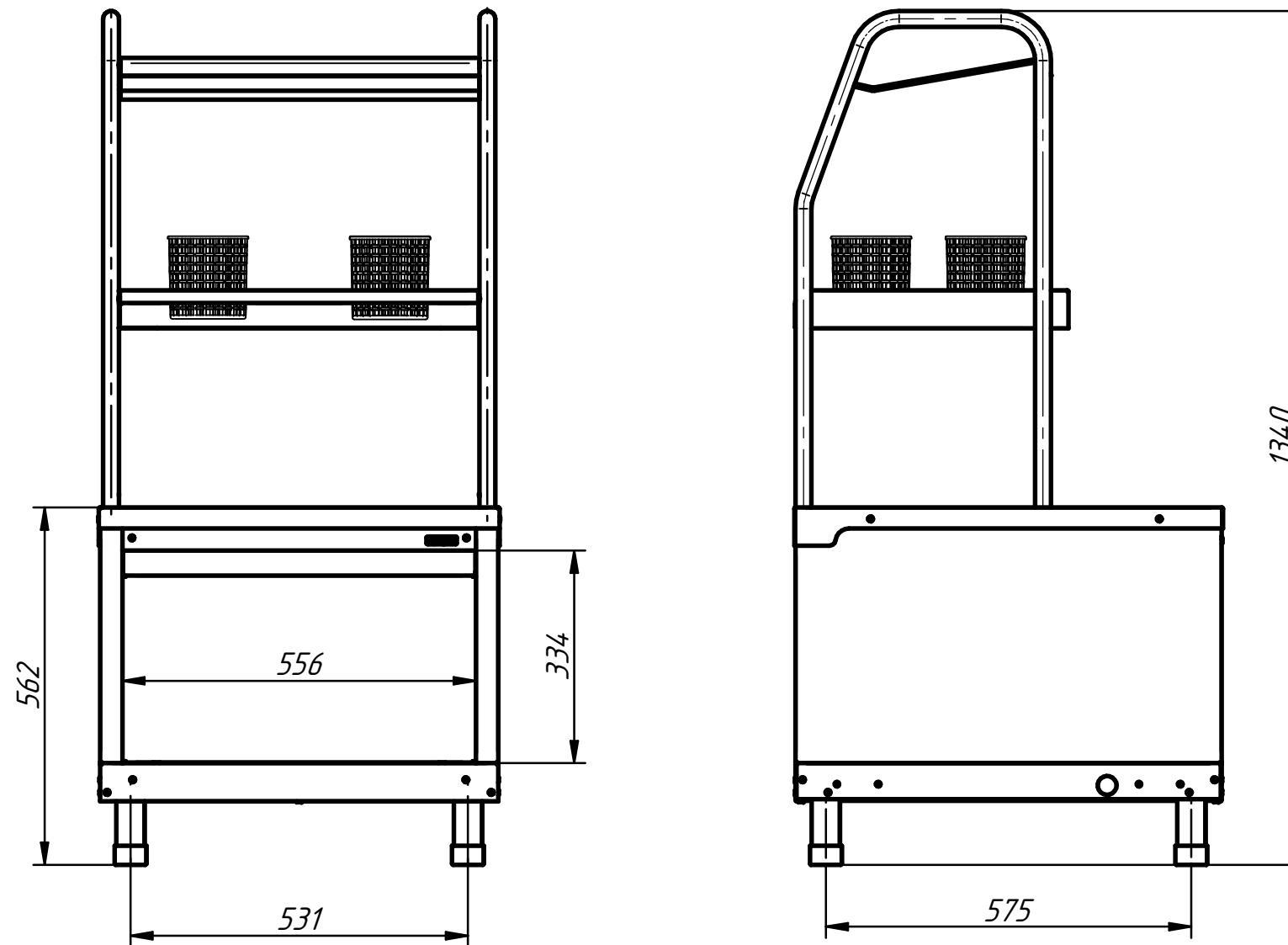
Прилавок столовых приборов и подносов предназначен для раздачи потребителям столовых приборов и подносов в составе линии раздачи. Прилавок имеет четыре нержавеющих емкости для вилок, ложек и ножей. Над прилавком установлена полка для нарезанного хлеба. Прилавок имеет регулируемые по высоте ножки.
