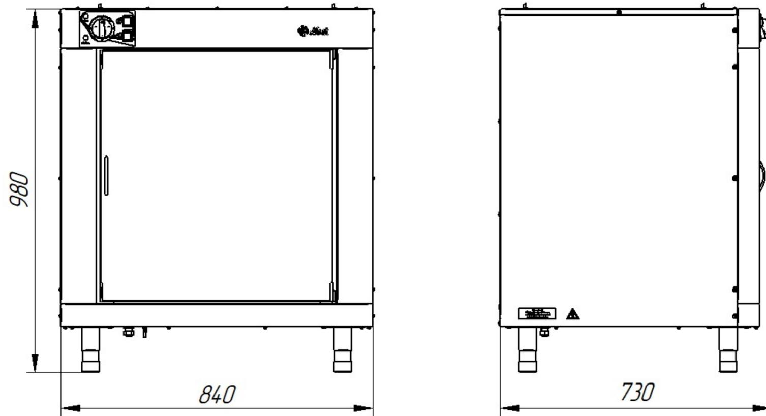
Шкаф расстоечный тепловой ШРТ-10-1/1М2 предназначен для расстойки мелкоштучных хлебобулочных и кондитерских изделий (или замороженных полуфабрикатов). Основной режим работы – расстойка продукта при температуре 45°C. Используется на предприятиях общественного питания в составе технологической линии с пароконвектоматами и конвекционными печами. Имеет 10 уровней для установки гастоуремкостей GN 1/1.
