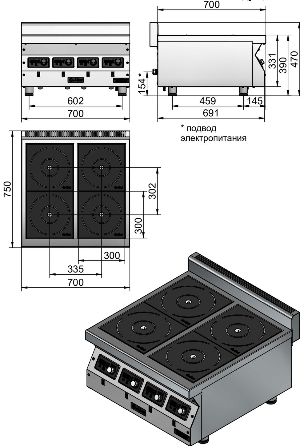
Плита индукционная кухонная настольная **КИП-47Н-5,0** предназначена для приготовления первых, вторых и третьих блюд в специальной наплитной посуде.
