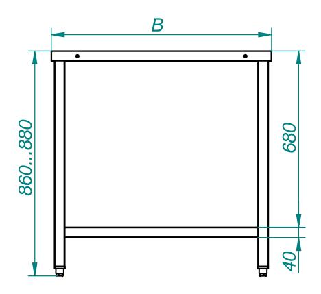
Подставка межплиточная предназначена для использования установки в тепловых линиях 700 и 900 серии. Столешница изготовлена из нержавеющей стали. Подставка имеет регулируемые по высоте ножки. Ножки и основание окрашенны порошковой краской. Конструкция подставки разборная.
