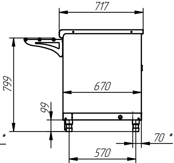
Прилавок тепловой электрический кухонный типа ПВТ предназначен для кратковременного хранения в теплом состоянии мелкоштучных хлебобулочных и кондитерских изделий и пищевых продуктов на тарелках, функциональных емкостях, подносах и раздаче их потребителю. Внутренний объем прилавка обогревается теплым воздушным потоком, создаваемый тепловентилятором. Направляющие для подносов входят в комплект поставки. Прилавок имеет регулируемые по высоте ножки. С лицевой стороны ножки закрываются фартуком.
