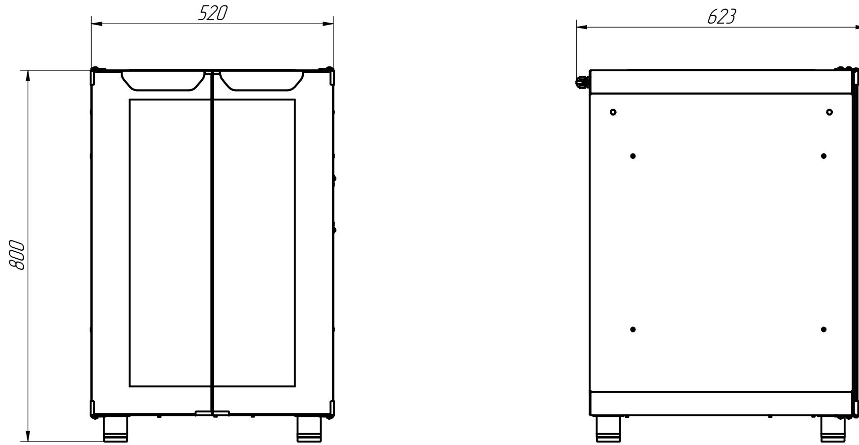
Шкаф расстоечный тепловой предназначен для расстойки мелкоштучных хлебобулочных и кондитерских изделий на предприятиях общественного питания. Основной режим работы – расстойка продукта при температуре 45° С. Шкаф может использоваться на предприятиях общественного питания как самостоятельно, так и в составе технологической линии. Внутренняя поверхность рабочей камеры выполнена из черного металла, покрытого высококачественной эмалью. Имеется лоток для сбора конденсата.
