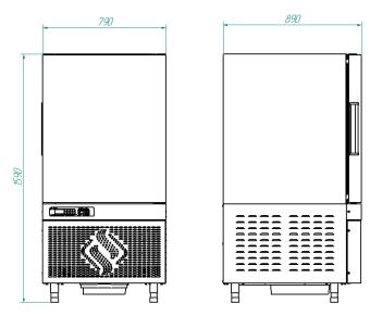
Шкаф шоковой заморозки ШОК-10-1/1AEF предназначен для быстрого охлаждения и замораживания различных пищевых продуктов на предприятиях общественного питания и торговли для дальнейшего их хранения.
