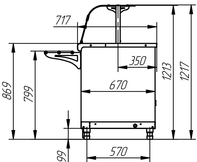
Прилавок-мармит электрический стационарный типа ПМЭС предназначен для кратковременного сохранения в горячем состоянии первых блюд в наплитных котлах и раздачи их потребителю. Регулировка мощности конфорок. Одна стеклянная полка над мармитом обеспечивает большую полезную площадь для выкладки порционных блюд. Над полкой оборудована лампа подсветки. На ваш выбор имеется большое количество вариантов быстросъемных фасадов. Направляющие для подносов входят в комплект поставки.
