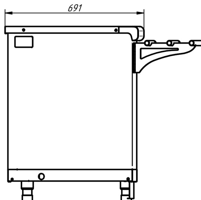
Модуль поворотный наружный предназначен для установки линии прилавков самообслуживания с поворотом на 45°. Модуль имеет регулируемые по высоте ножки. С лицевой стороны ножки закрываются фартуком. Наружный поворотный модуль имеет направляющие для подносов (входят в комплект поставки).
