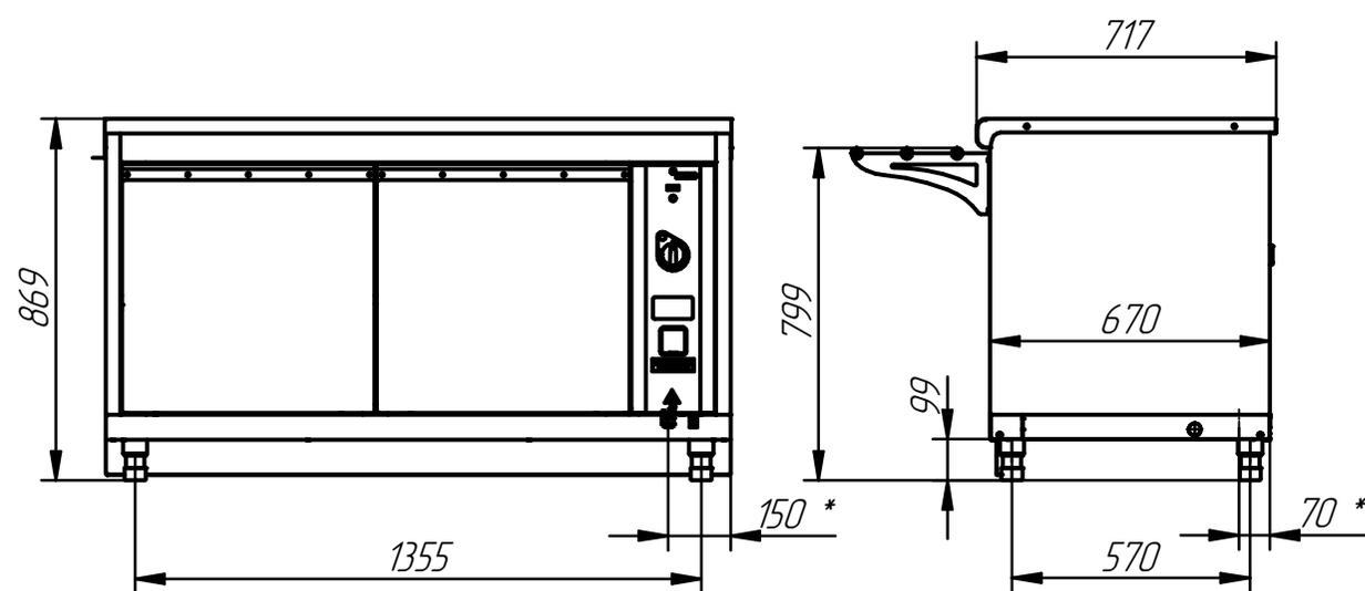
Прилавок тепловой электрический кухонный типа ПВТ предназначен для кратковременного хранения в теплом состоянии мелкоштучных хлебобулочных и кондитерских изделий и пищевых продуктов на тарелках, функциональных емкостях, подносах и раздачи их потребителю. Внутренний объем прилавка обогревается теплым воздушным потоком, создаваемый теплоventилиятором. Направляющие для подносов входят в комплект поставки. Прилавок имеет регулируемые по высоте ножки. С лицевой стороны ножки закрываются фартуком.
