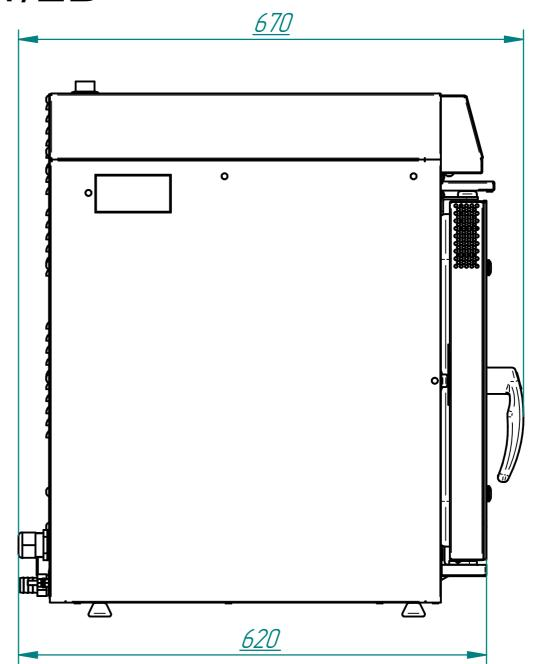
Пароварочный конвективный аппарат электрический кухонный предназначен для приготовления продуктов питания на различных режимах: -конвекция
