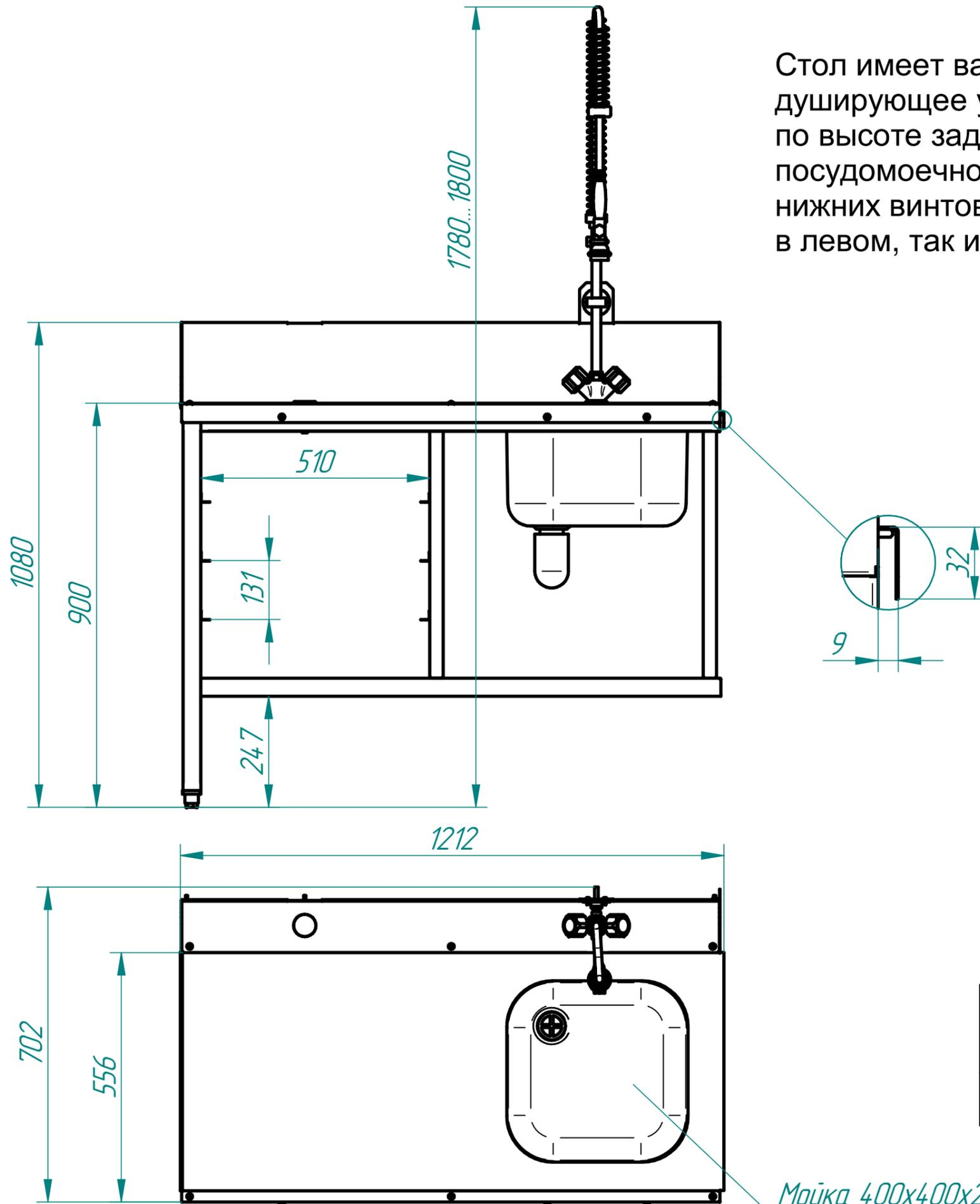
Стол имеет ванну для предварительного ополаскивания посуды, душирующее устройство для холодной и горячей воды, регулируемые по высоте задние ножки, место для установки 4-х кассет. Крепление к посудомоечной машине осуществляется с помощью верхнего зацепа и нижних винтов. Путем несложного монтажа стол можно установить как в левом, так и в правом исполнении.
