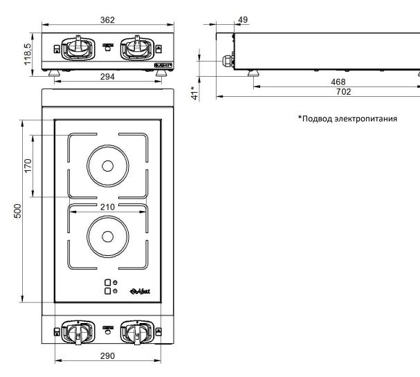
Плита индукционная кухонная настольная КИП-2Н предназначена для приготовления первых, вторых и третьих блюд в специальной наплитной посуде. Посуда должна быть с плоским дном, обладающая магнитными свойствами: посуда из нержавеющей стали или алюминия с ферромагнитным дном, чугунная посуда (посуда, к которой притягивается магнит).
