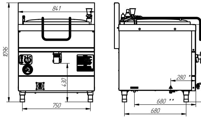
Котлы пищеварочные газовые типа КПГМ предназначенны для приготовления бульонов, третьих блюд и кипячения воды. Котлы используются на предприятиях общественного питания самостоятельно или в составе технологических линий. Сосуд котлов выполнен цельнотянутым из корозионностойкой стали AISI304. Удобная крышка фиксируется в любом положении. Слив готового продукта через кран 1 1/2" на передней панели.
