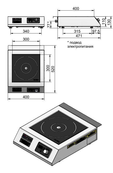
Плиты индукционные кухонные настольные **КИП-1H-3,5** и **КИП-1H-5,0** предназначены для приготовления первых, вторых и третьих блюд в специальной наплитной посуде.
