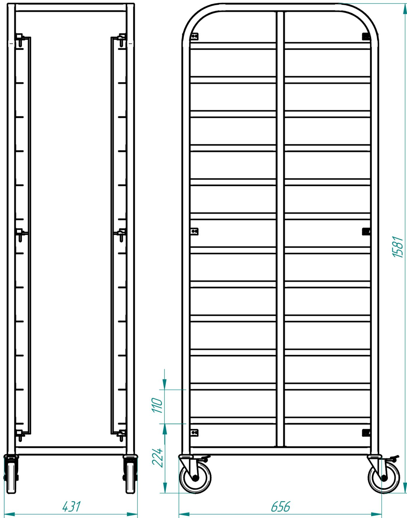
Тележка-шпилька ТШГ-12 для противней 350x600 является вспомогательным оборудованием для предприятий общественного питания и используются для установки и транспортировки противней размером 350x600. Тележка имеет поворотные колеса, два из которых оборудованы стопором. Тележка изготовлена из нержавеющей стали.
