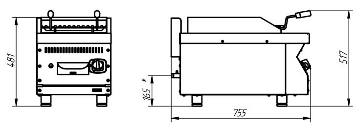
Газовый гриль ГК-40Н предназначен для приготовления пищи путем непосредственного контакта решетки гриля с одной стороной обрабатываемого продукта, полуфабрикатов из мяса, рыбы, овощей на предприятиях общественного питания, как самостоятельно, так и в составе технологических линий. Работает как от природного, так и от сжиженного газа. Имеет регулируемые по высоте ножки.
