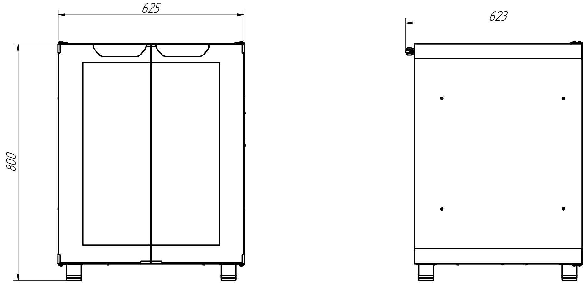
Шкаф расстоечный тепловой предназначен для расстойки мелкоштучных хлебобулочных и кондитерских изделий на предприятиях общественного питания. Основной режим работы – расстойка продукта при температуре 45 ° С. Шкаф может использоваться на предприятиях общественного питания как самостоятельно, так и в составе технологической линии. Камера и наружные поверхности выполнены из высококачественной нержавеющей стали. Имеется лоток для сбора конденсата.
