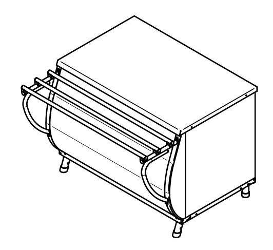
Прилавок для горячих напитков (нейтральный стол), предназначен для кратковременного хранения и раздачи потребителю хлебобулочных и кондитерских изделий, а также для установки на его столе термостата с напитками. На прилавке установлена розетка 230 В для подключения термостата или кипятильника. Внизу нейтральный шкаф для хранения кухонного инвентаря. Направляющие для подносов входят в комплект поставки. Прилавок имеет регулируемые по высоте ножки.
