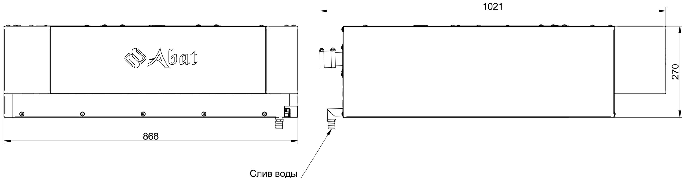
Зонт вытяжной встраиваемый с пароконденсатором ЗВВ-5-6-4П монтируется совместно с конвекционной печью КЭП-5ПП, как при установке в стойке (5+0), так и при установке в колонне (5+5). Зонт предназначен для вытяжки и конденсации отработанного пара в конвекционной печи типа КЭП-5ПП в стойке (5+0), в колонне (5+5) на объектах общественного питания, а также очистки воздуха от аэрозолей жира, масла и производственных запахов в закрытых помещениях.
